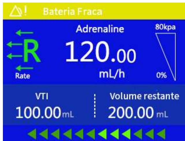
Figura 8-9 Alarme de Bateria Fraca
