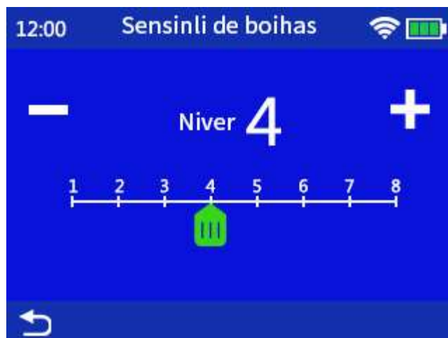
Figura 9-3 Ajuste de sensibilidade de detecção de ar na linha
