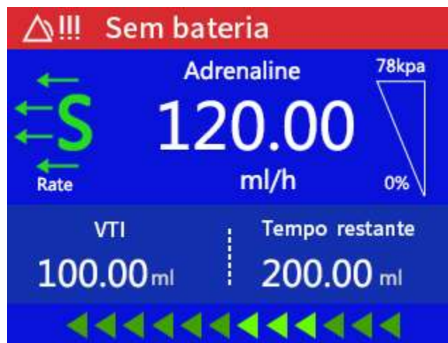
Figura 8-5 Alarme de falta de bateria
