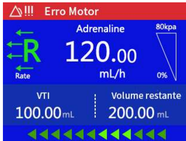
Figura 8-7 Alarme de Erro no Motor
