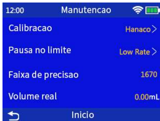
Figura 10-1 Calibração para precisão do conjunto de infusão
