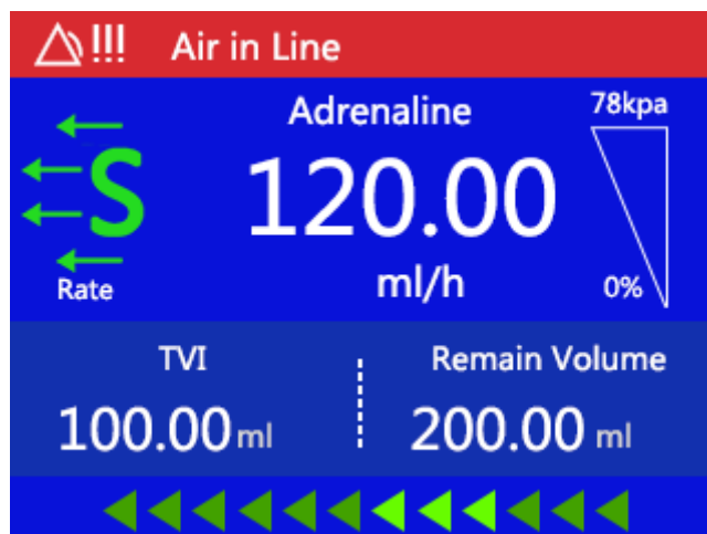
Figura 8-5 Alarme de ar na linha
