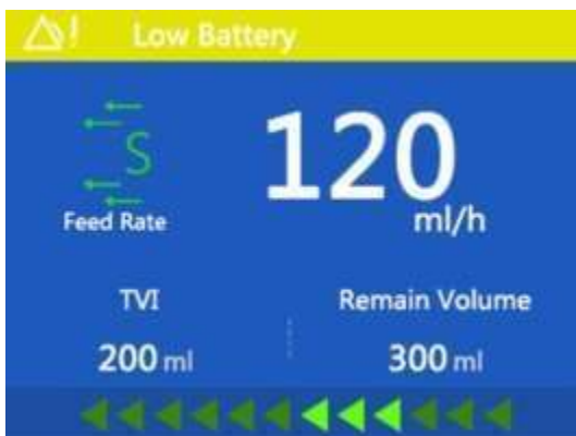
Figura 13-6 Alarme de bateria fraca
