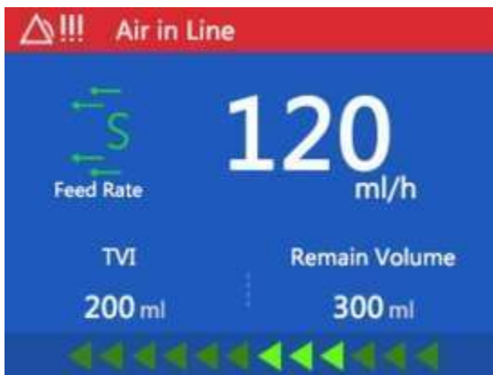
Figura 13-2 Alarme de ar na linha
