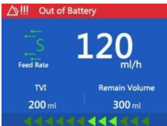
Figura 13-3 Alarme de bateria fora
