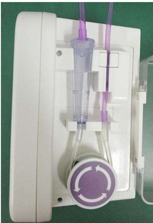
Figura 12-1 Instalação do conjunto de alimentação enteral
