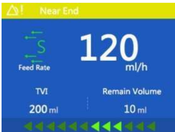
Figura 13-7 Alarme de fim próximo
