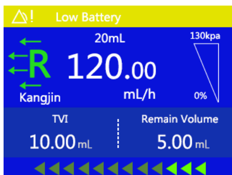
Figura 8-9 Alarme de bateria fraca
