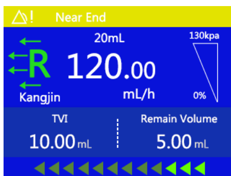
Figura 8-10 Alarme de injeção próxima do fim
