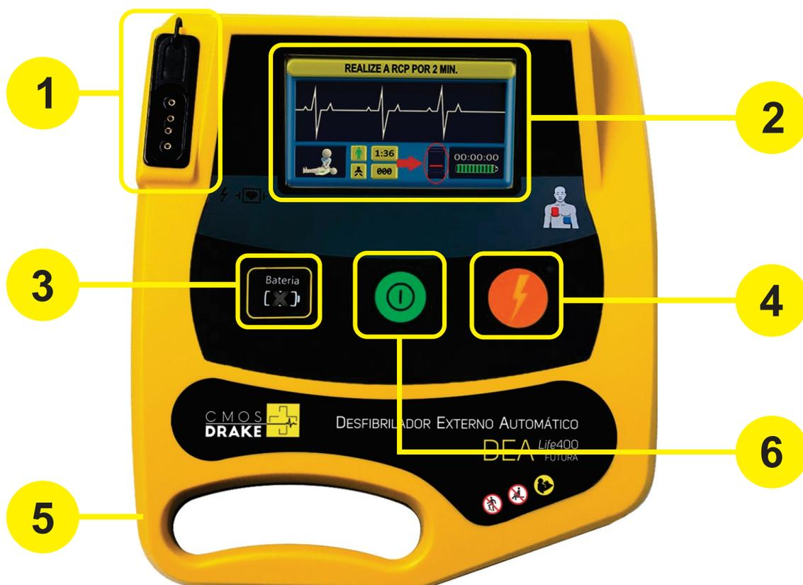
**1** Conector das pás de choque (eletrodos) e Dispositivo de Feedback de RCP.
